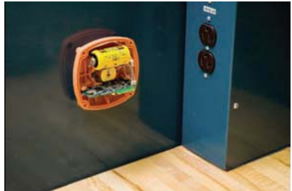
Rysunek 8.1: Pozycja ustawienia akcelerometru nadajnika StatusCheck
